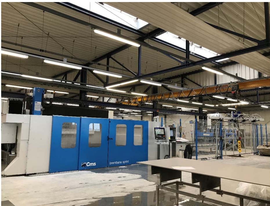
Gesamte Maschinenanlage mit Verarbeitungszentrum und Ladestation umfasst eine Länge von ca. 20 Metern.
